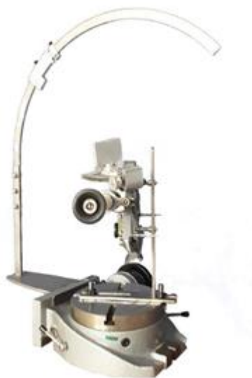
Рисунок 8 – Совмещение оси трубы с осью коллиматора, вид на станд
