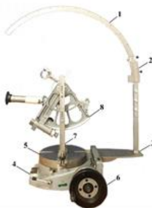
Рисунок 3 – Поверочный стенд «Сфера» с установленным СПБЗ вид сбоку: 1 – Высотный лимб; 2 – Коллиматор высотного лимба с отсчетно-стопорным устройством; 3 – Кронштейн высотного лимба; 4 – Поворотный стол; 5 – Азимутальный лимб; 6 – Отсчетно-стопорное устройство азимутального лимба; 7 – Кронштейн для крепления секстанса; 8 – СПБЗ
