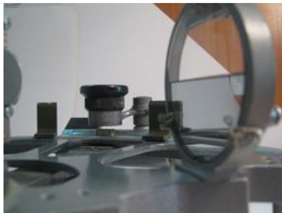
Рисунок 6 – Проверка перпендикулярности малого зеркала по равенству уровней верхних кромок прямовидимого и отражённого лучей диоптров
